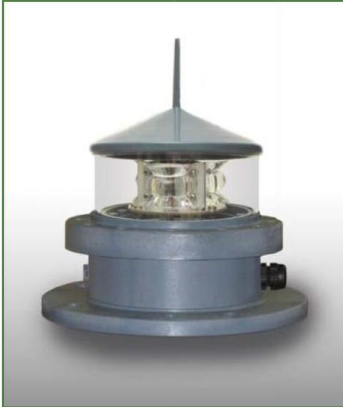
A MBL 160 é uma lanterna marítima de LED piscante de curto e médio alcance, com excelente desempenho de seu sistema óptico e baixo consumo, equipado com diodos de LED de alta intensidade, proporcionando uma faixa luminosa de até 16 milhas náuticas.
